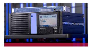
THE RTDS SIMULATOR IS USED TO TEST A REAL-TIME AUTOMATION CONTROLLER
